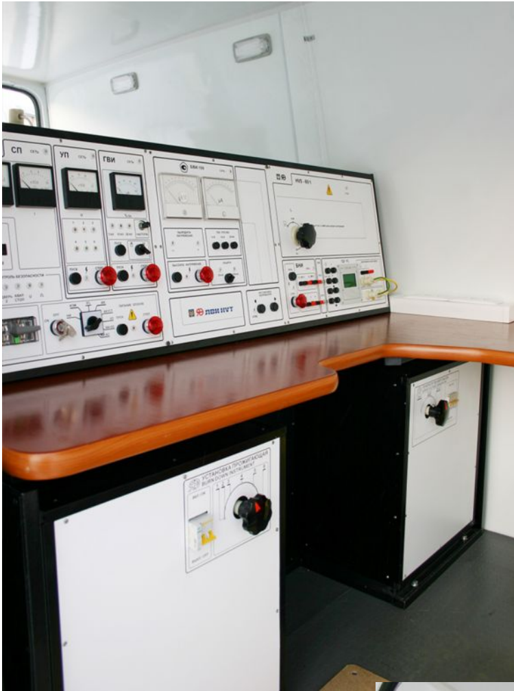
Вид на высоковольтный отсек лаборатории ЛВИ ИВТ -2FAV базе Ford Tranzit
