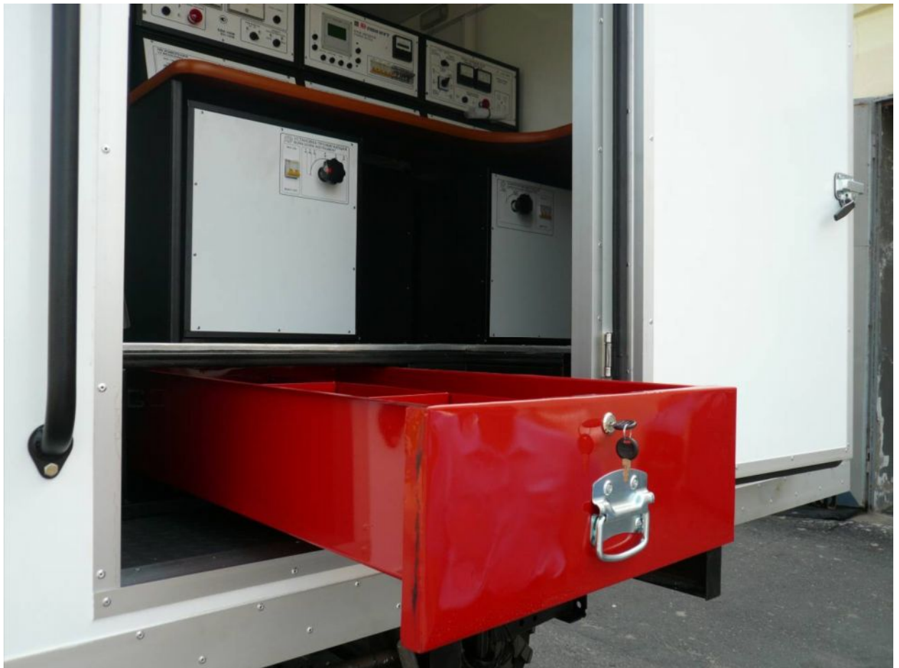
Вид на высоковольтный отсек лаборатории ЛВИ НVT-2AG на базе ГАЗ-3308
